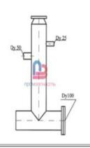
КУВ тип VII - камера Ду 100 с переходом 100х65, с давлением Ру 4,0 Мпа до Ру 6,3 Мпа - используется для уровнемеров "Сапфир" модели 2622 для вязких сред
